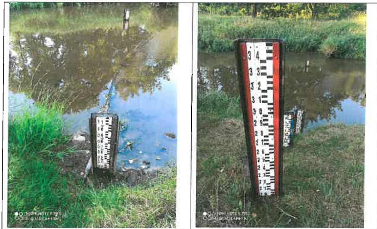
Fot.1 Wodowskazy na rzece Kamiennej.
